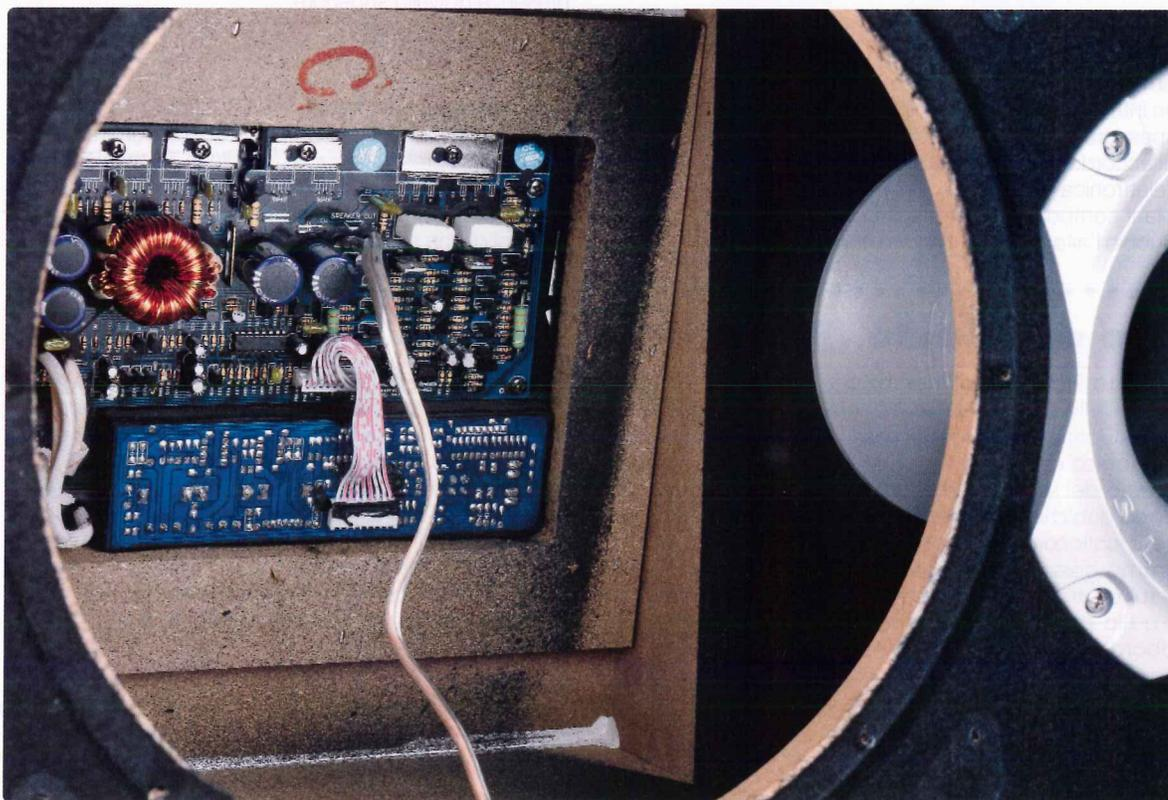
Tolto l'altoparlante, troviamo subito l'elettronica di controllo e l'amplificazione che utilizza un classico finale a ponte.
